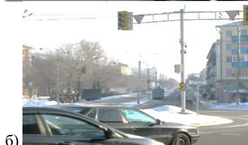
Рисунок 3. Дислокация знаков 5.33 на перекрестке ул.Сагадата Нурмагамбетова- пр.Ауэзова- ул. Протазановаа-выделен знак 5.33, сливающийся с фоном здания, б- хорошо видимый знак 5.33, расположенный справа от проезжей части дороги.
