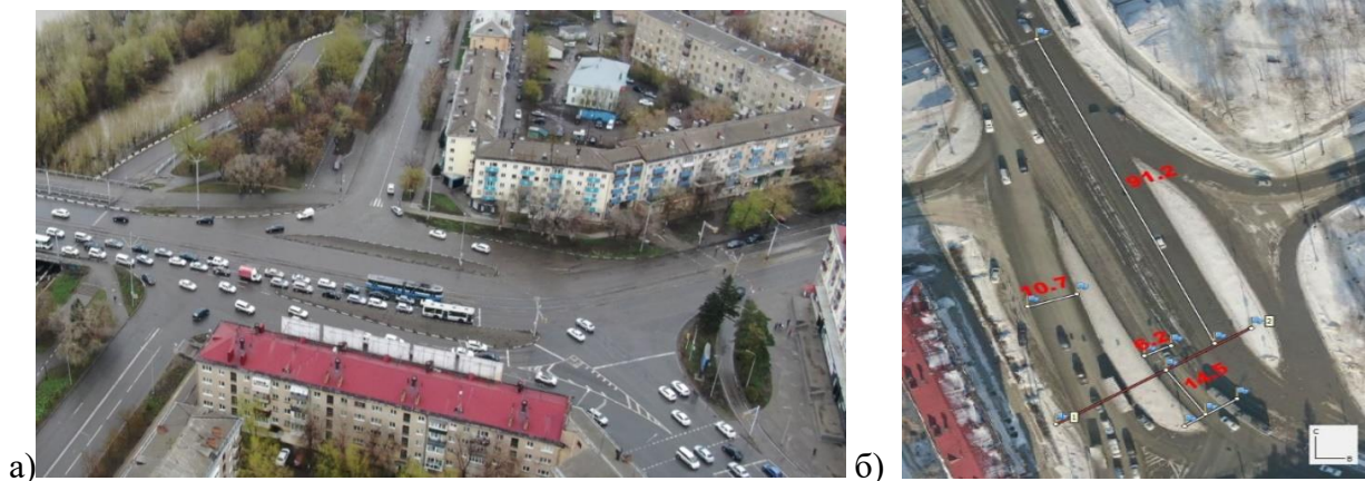
Рисунок 2. Перекресток ул.Сагадата Нурмагамбетова- пр.Ауэзова- ул. Протазанова, а-технические средства организации дорожного движения в летний период и затор, вынуждающий останавливаться на мосту, б-цифровая модель перекрестка в зимнее время
